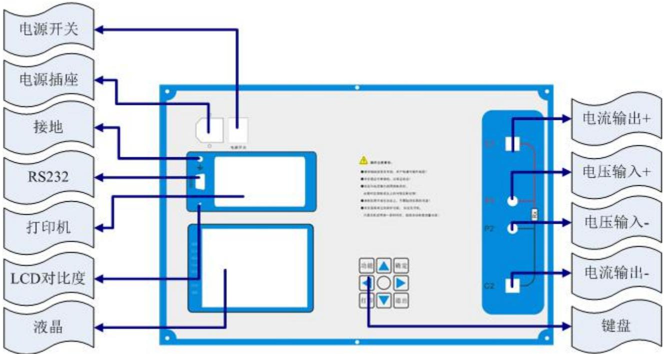
图 2 面板结构图
